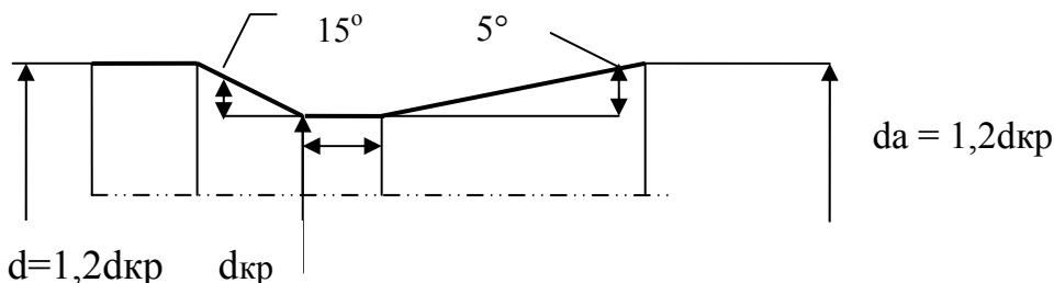
B.18.10 Диаметр критического сечения сопла насадка ( $D_{kp}$ , м) рассчитывается по формуле:
