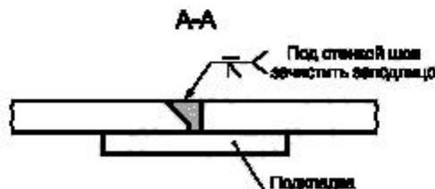
Рисунок 4 — Переход от нахлесточного к стыковому соединению полотнищ
