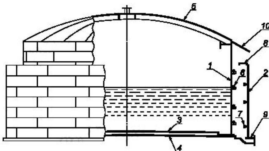
1 — основная стенка; 2 — защитная стенка; 3 — основное днище; 4 — защитное днище;
