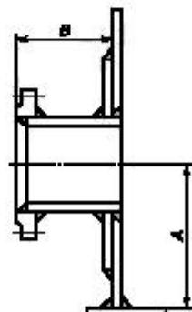
Рисунок 11 — Типы патрубков в стенке (условно показаны патрубки с фланцами типа 01 и круглыми усиливающими листами)
