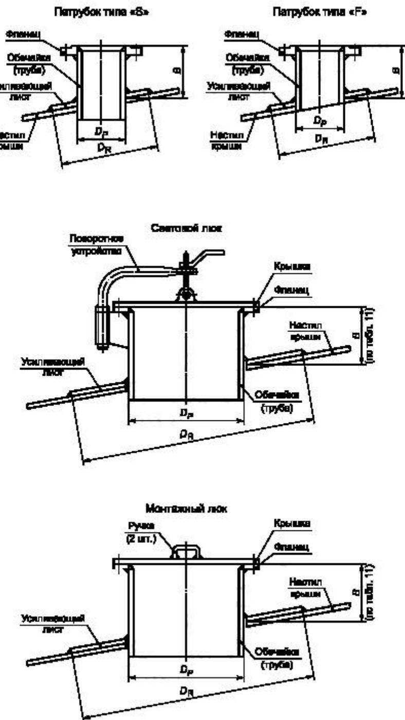
Рисунок 16 — Патрубки и люки в крыше
