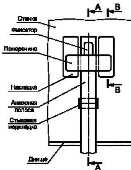
Рисунок 21, лист 1 — Крепление стенки анкерными полосами
