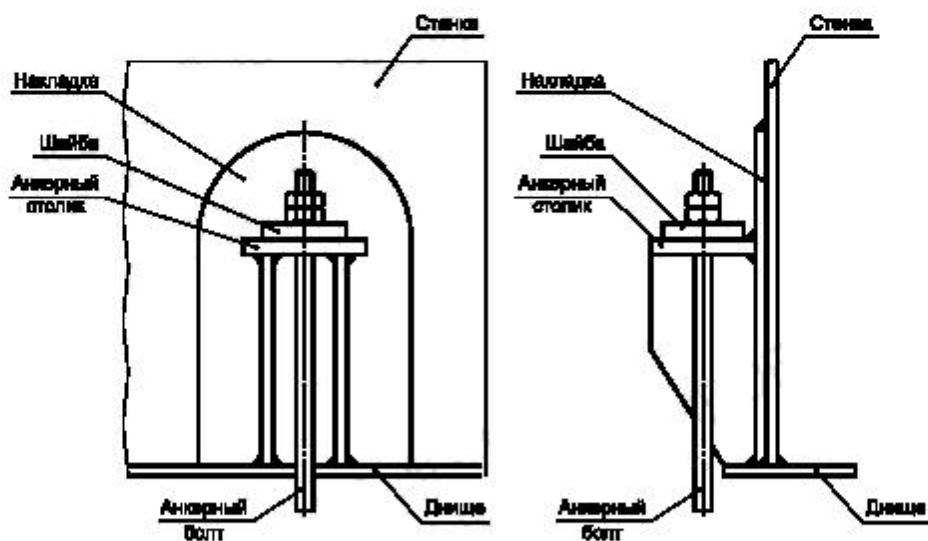
Рисунок 20, лист 1 — Крепление стенки анкерными болтами
