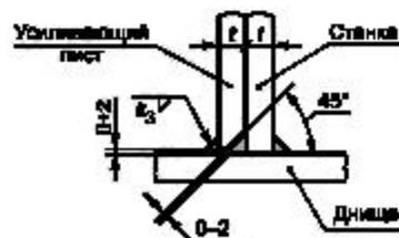
Рисунок 8 — Детали патрубков и люков в стенке
