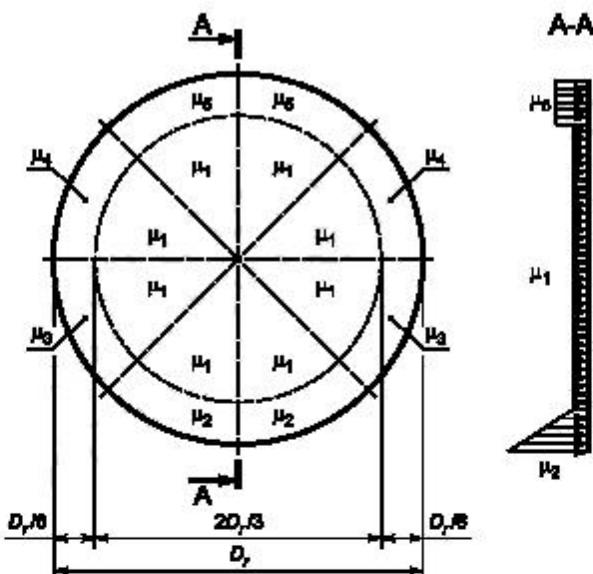
Рисунок 18 — Неравномерное распределение снеговой нагрузки на плавающей крыше
