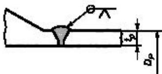
Рисунок 12 — Соединение фланца патрубка с обечайкой (трубой)
